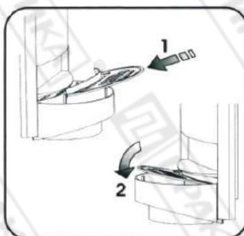
Вставьте решетку, как показано на рисунке), сначала закрепив её язычок, а затем немного повернув его, пока он не займет правильное положение.
