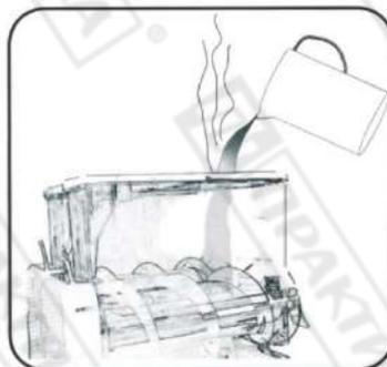
Выключите питание. Наполните резервуар теплой водой и опорожните его через кран.
