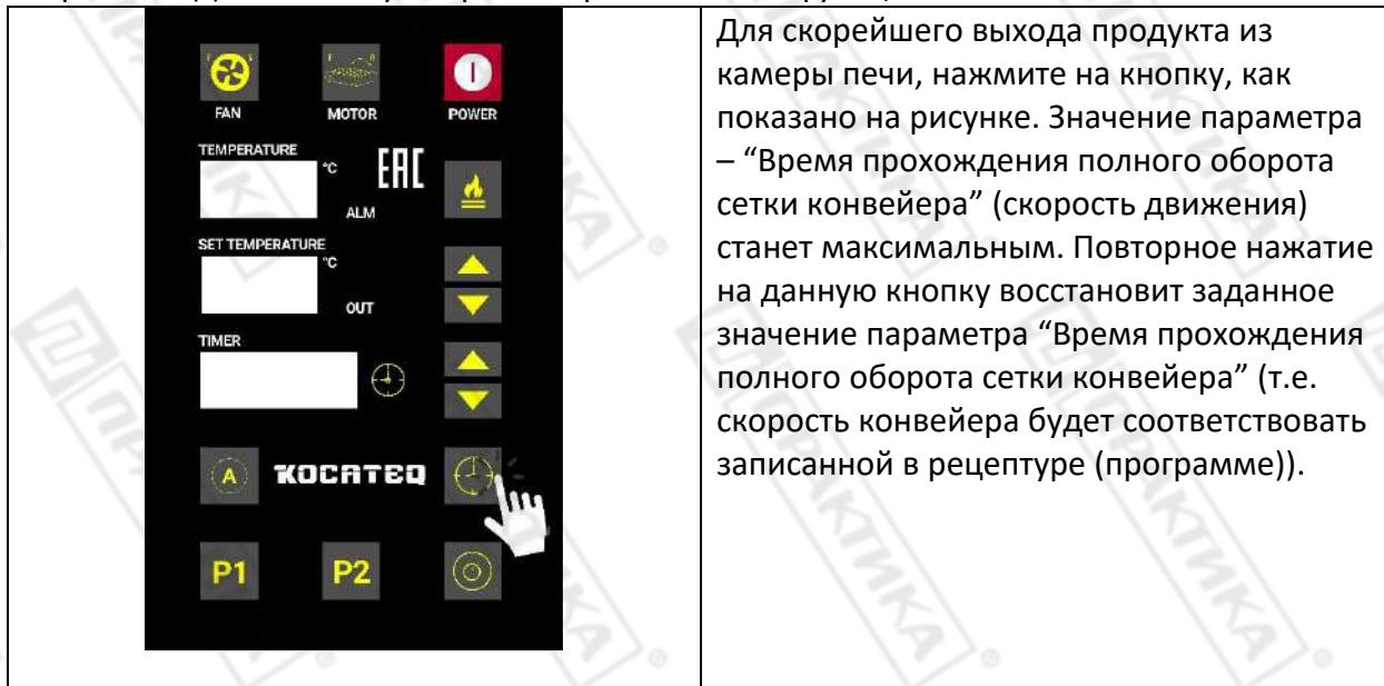
Для скорейшего выхода продукта из камеры печи, нажмите на кнопку, как показано на рисунке. Значение параметра – “Время прохождения полного оборота сетки конвейера” (скорость движения) станет максимальным. Повторное нажатие на данную кнопку восстановит заданное значение параметра “Время прохождения полного оборота сетки конвейера” (т.е. скорость конвейера будет соответствовать записанной в рецептуре (программе)).
