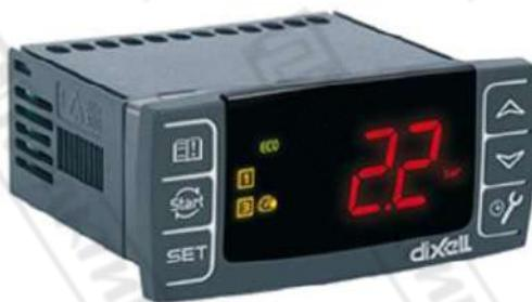
Dixell XR06CX – это микропроцессорный контроллер, подходящий для применения в средне- и низкотемпературных блоках охлаждения с вентиляцией. У него есть три релейных выхода для управления компрессором, вентилятором и оттайкой, которая может быть либо электрической, либо с реверсивным циклом (горячим газом). Прибор также снабжен 2 входами для датчиков NTC. Также он снабжен конфигурируемым цифровым входом. Имеется возможность легко и быстро запрограммировать контроллер с помощью ключа HOTKEY.
