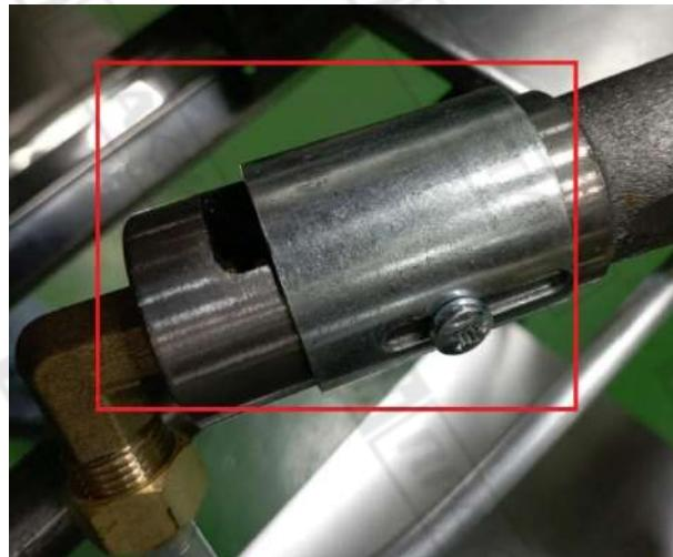
Регулировка соотношения газ/воздух осуществляется путем изменения положения регулировочной трубы. Регулировка должна осуществляться на выключенном оборудовании с последующей проверкой качества горения.
