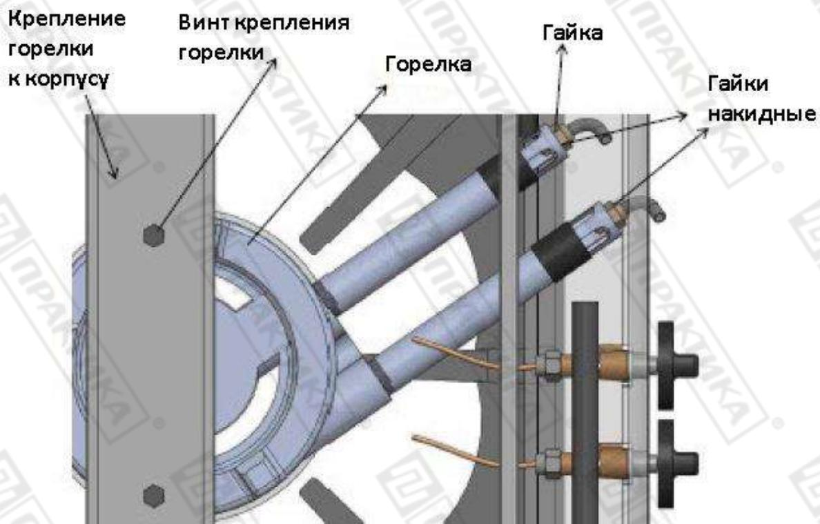
Открутите винты крепления горелки подходящим ключом
