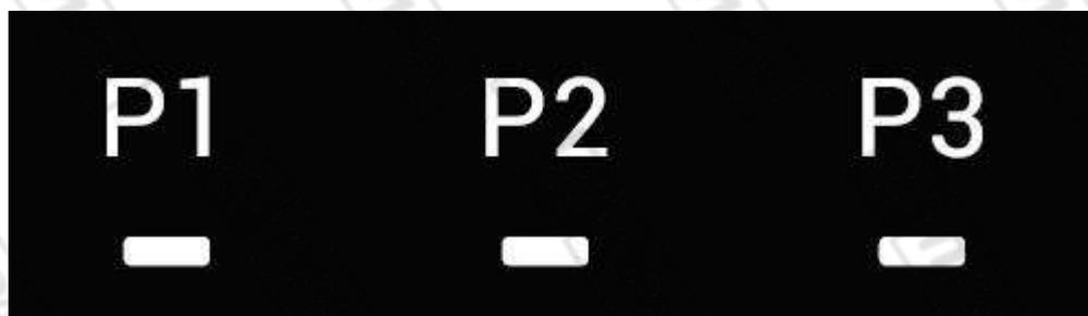
В верхней части панели управления есть три кнопки, P1, P2 и P3, каждая из которых соответствует фазам приготовления. С каждой кнопкой связан индикатор, показывающий состояние этапа. Рисунок 14. Кнопки и индикаторы фазы приготовления
