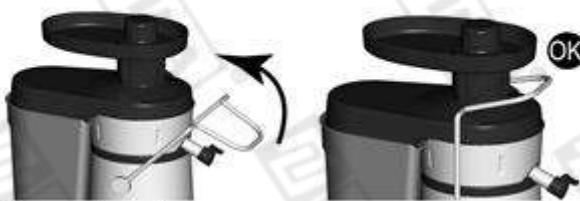
Закройте предохранительный рычаг. Чтобы запустить машину, нажмите кнопку ВКЛ. Соковыжималка не запустится, если предохранительный рычаг не закрыт должным образом.
