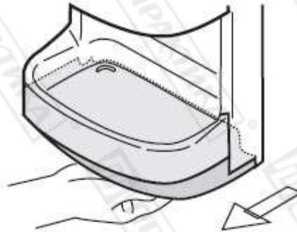
Открутите два винта, фиксирующих каплесборник.
